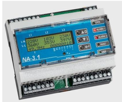
Unterschreitung der vorgegebenen Grenzwerte  $U \ll$ ,  $U <$ ,  $U >$  und  $U \gg$  für die parametrierbare Auslöseverzögerung fällt das zugeordnete Ausgangsrelais ab.
